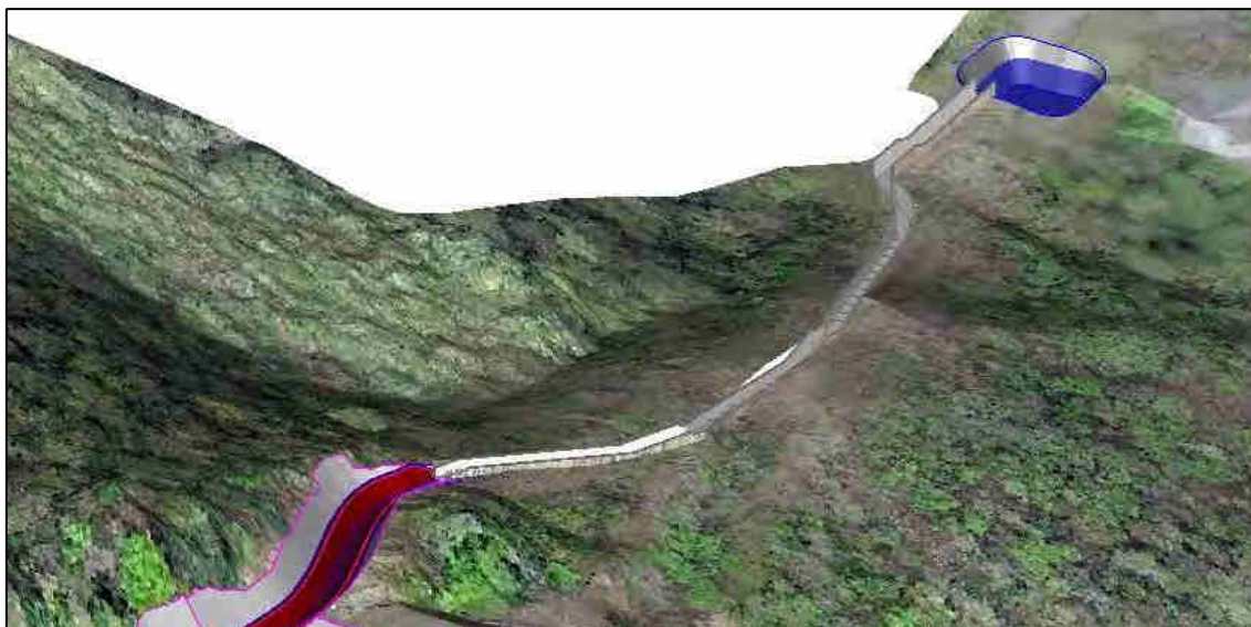
Figura 3.11 – Escadaria de concreto projetada e bacia de dissipação - Vista superior
