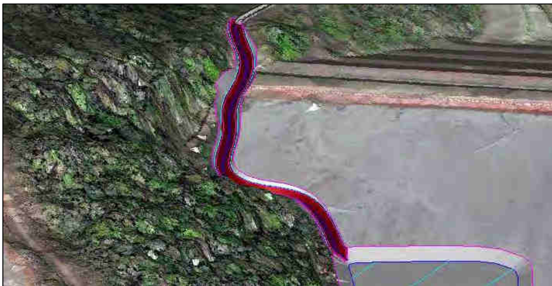
Figura 3.9 – Etapa 3: Extravasor da ombreira esquerda
