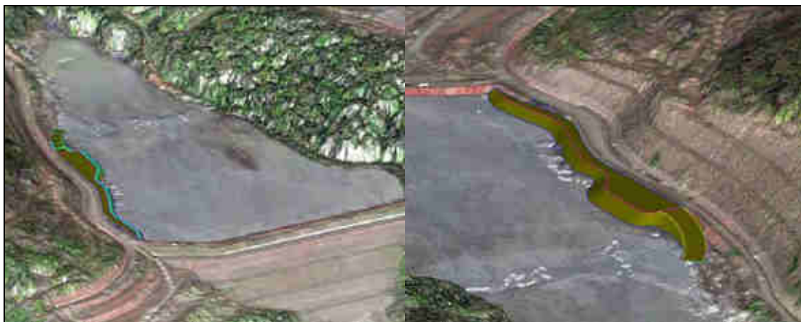
Figura 3.5 – Aterro de conquista, estéril compactado dentro do reservatório da B4
