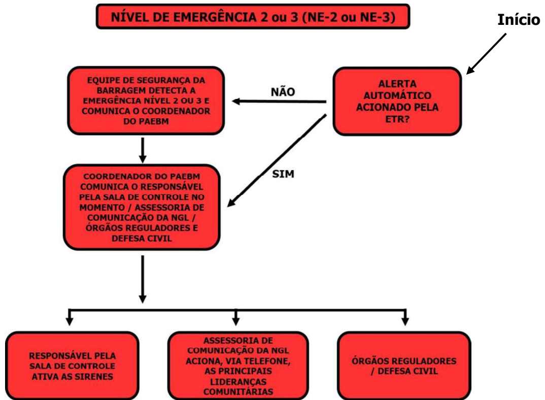
Figura 11.1 – Fluxograma para o acionamento do sistema de alarme
