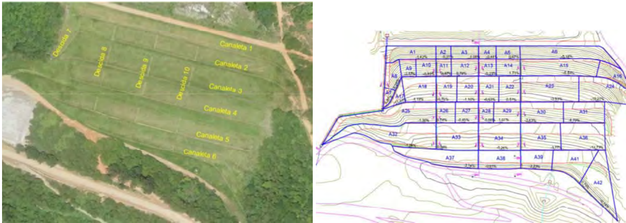
Figura 11. Sistema de drenagem superficial presente na barragem (fonte: NG-15-EH-MR-RL-R2).
