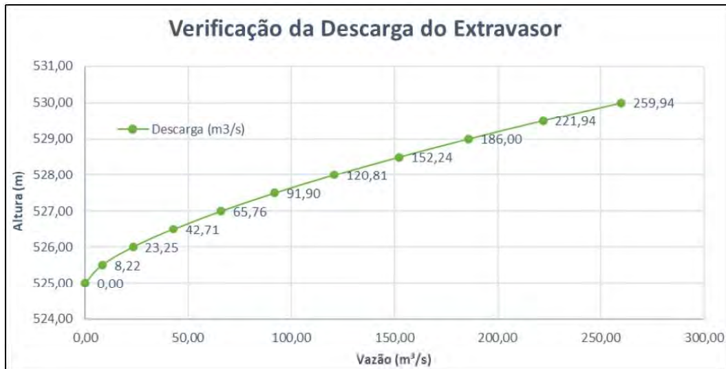
Figura 9 – Curva de descarga do extravasor (fonte: NG-04-EH-RC-RL-R0).
